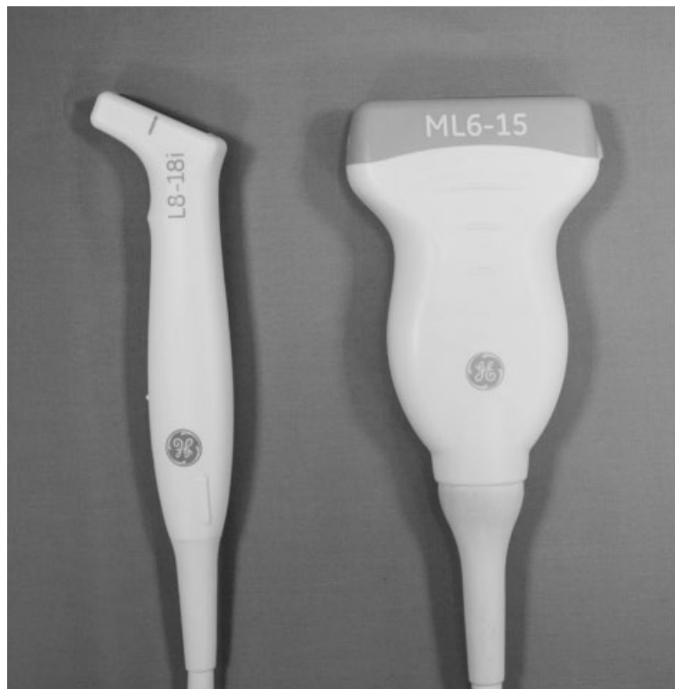
รูปที่ 1. แสดง transducer probe ชนิด linear ที่ใช้ใน musculoskeletal ultrasonogram
